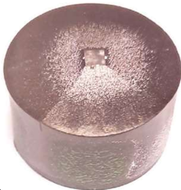
GdBCOAg masívny monokryštalický supravodič
