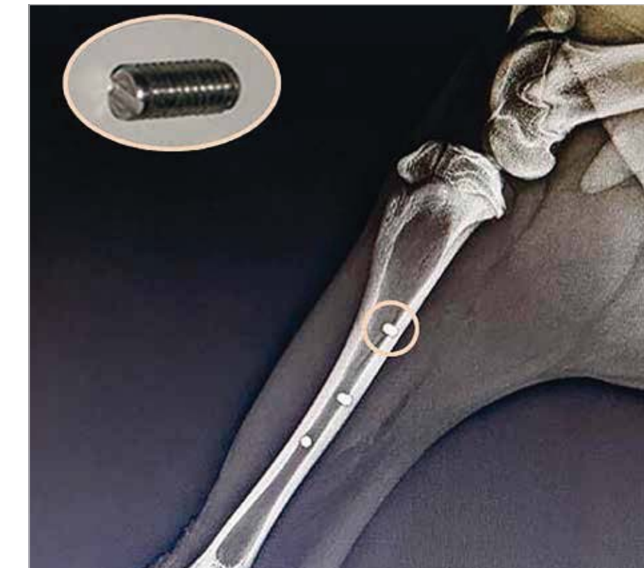
Implantát z Ti + 12% Mg kompozitného materiálu implantovaný do stehennej kosti ovce v rámci in-vivo testov.
